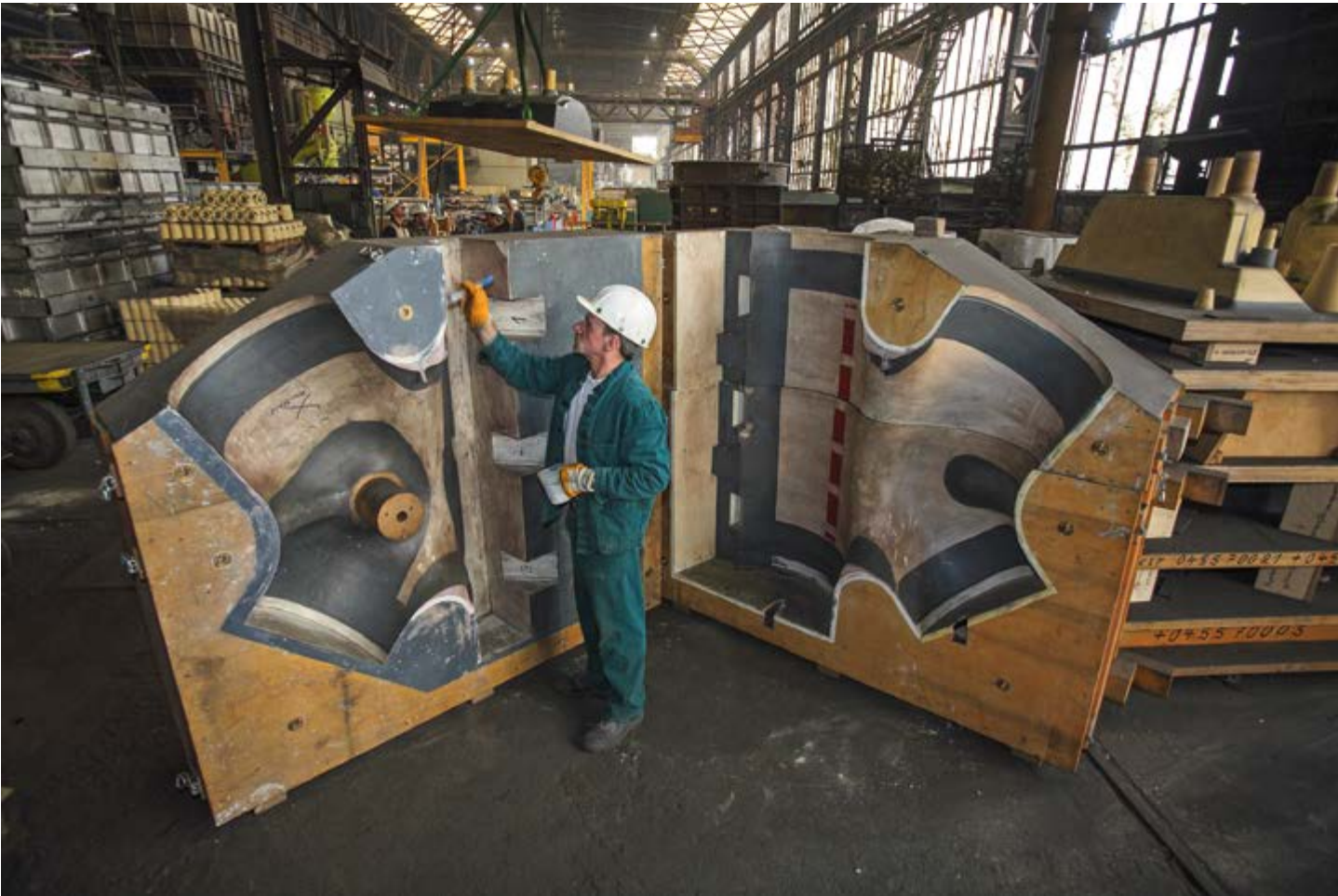
Von der Ruhr in die Nordsee: Der Handformer prüft den Kernkasten eines Stahlgussknoten für das Fundament eines Offshore-Umspannwerkes (Mülheim/Ruhr)
