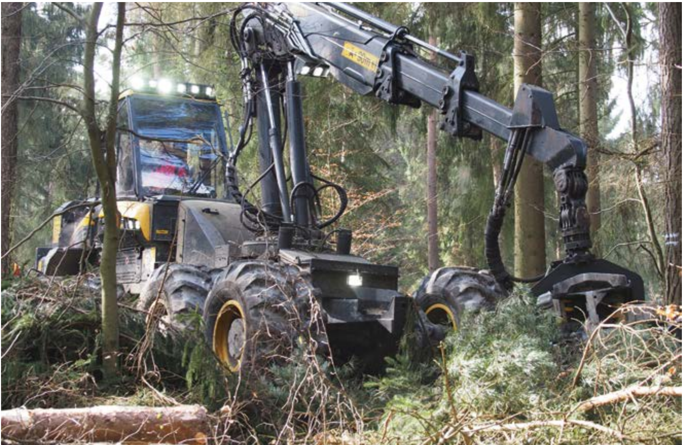
Holzernte in der Rureifel: Traktionshilfswinden und Bogiebänder minimieren Bodenerosion oder -verdichtung.
